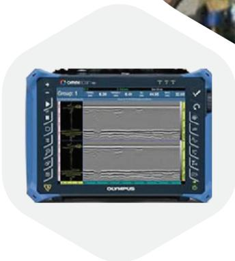
La diffraction par temps de vol est l'une des techniques les plus avancées de l'examen par ultrasons. La méthode repose sur le phénomène de diffraction des ondes ultrasonores qui créent des images virtuelles des discontinuités présentes dans les parties examinées. Cette méthode présente un degré de précision plus élevé que toute autre méthode d'échographie et est considérée comme l'une des méthodes de CND les plus rapides car un joint peut être examiné en un seul balayage.
